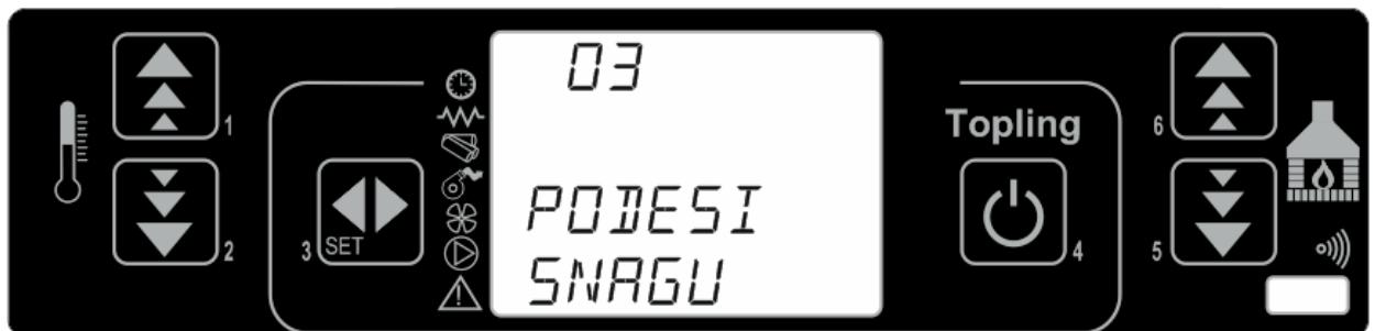
Slika 3. – Podešavanje željene snage kotla
