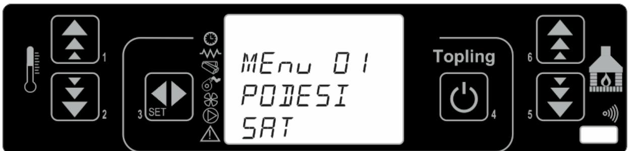
**Slika A.** – Podešavanje tačnog vremena i datuma upravljačke automatičke
